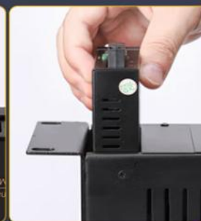
3. 将安装好支架的收发器插入机架中
