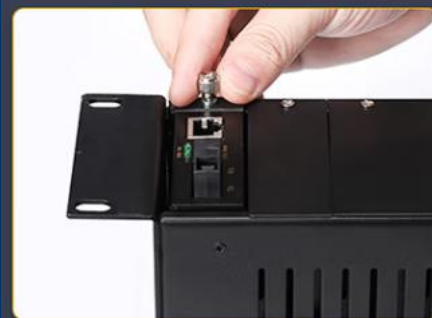
4. 拧紧收发器挡板上的螺丝, 将收发器固定在机架上
