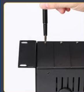
1. 用螺丝刀拧下机架上的螺丝, 打开盖板
