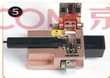
5 用定长器切除多余光纤
